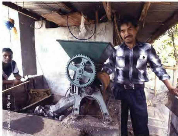
Met een ontpulper wordt het vruchtvlees van een koffiebes verwijderd.
